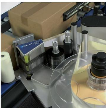
In vielen Fällen werden die Packungen bereits von der Mittellinie an die Seite des Förderbands geführt und so ist keine zusätzliche Packungshandhabung erforderlich, um vom Stempel- oder Blasapplikator zum Direct Apply-Etikettieren zu wechseln.
